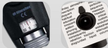
La raya y el punto se giran 360° con el tornillo moleteado. El ángulo se lee directamente en la escala.
